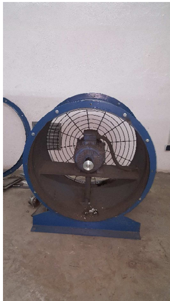
Imagen 5: Ventilador averiado y desmontado
